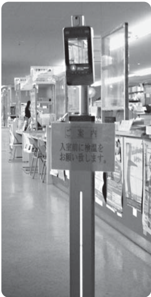
庁舎に設置されたサーマルカメラ
