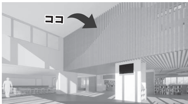
▲吹き抜け空間の落下防止柵
